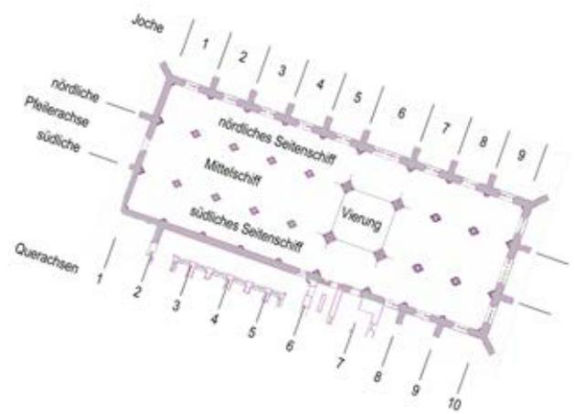
Abb. 6: Münster Neuberg, geodätisch erfasster Grundriss (Aufnahme in einem lokalen System,<sup>22</sup> Plan vom Verfasser genodet). – Für die weiteren Betrachtungen wurde der Plan auf Wände und Pfeiler reduziert und mit Begriffen versehen. Die Darstellung wurde für CAD<sup>23</sup> aufbereitet, sodass in ihr gemessen und konstruiert werden kann.
